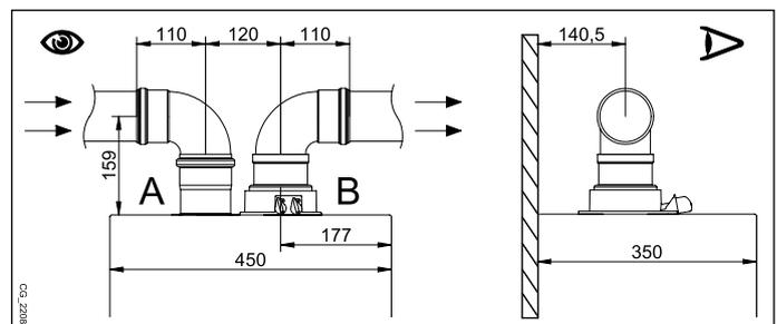
El codo de 90° permite conectar la caldera a los conductos de descarga y aspiración, adaptándose a las diferentes exigencias. También se puede utilizar como codo suplementario acoplado al conducto o al codo de 45°.
