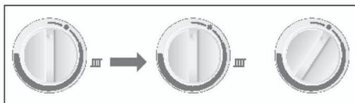
Configurar la temperatura del ACS de la caldera girando la perilla de control en dirección de las manillas del reloj hasta que la temperatura deseada aparezca en la pantalla LCD entre los puntos "Max" y "Min", el punto de ajuste para la temperatura del Agua Caliente Sanitaria en modo verano es 35-64°C.
