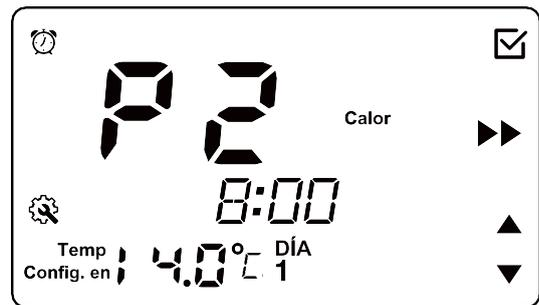
E. Presione  ⇌ ▲/▼ ⇌  para completar la configuración del horario de Temperatura y Hora para cada periodo de programa (P1-P6) del día.
