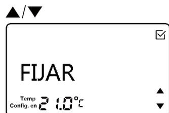
Presione  para activar el modo de mantener de temperatura.
