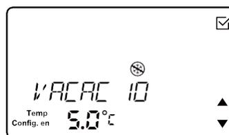
Utilice **▲/▼** para seleccionar la temperatura deseada. El rango de ajuste de la temperatura es de 0 °C a 10 °C.
