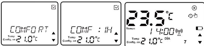
4. Presione  para confirmar la configuración y activar el modo de accionamiento de CONFORT,
