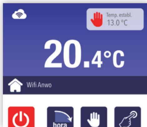
Paso 5. Presione el ícono del modo de Espera Permanente
